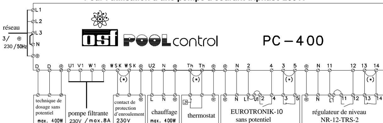
Le pont introduit à l'usine entre les deux bornes nommées *Th* doit être enlevé si l'on branche un thermostat externe. Si aucun branchement n'a lieu, il doit rester en place.
