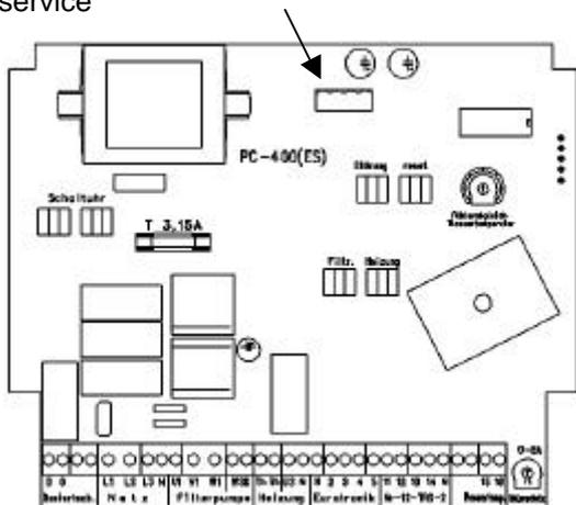
Pour faciliter la mise en service et le diagnostic d'erreurs, il est possible de raccorder un terminal de service osf à cette commande (N° art. 3010000900). La prise de raccordement se trouve sur la carte imprimée à l'intérieur de l'appareil.
