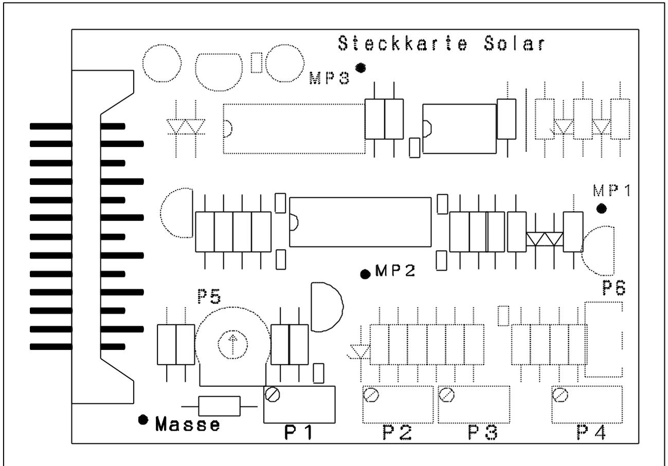
Zum Abgleich der Beckenwassertemperatur wird mittels Potentiometer P 2 eine der gemessenen Wassertemperatur entsprechende Spannung an Meßpunkt MP 1 eingestellt. Dabei entsprechen 0,1 Volt einem Grad Celsius.
